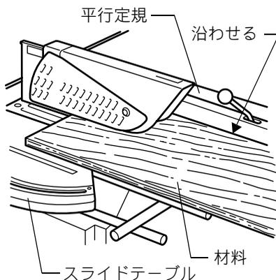
② 平行定規をルーラーガイドに沿わせて入れ、お望みの切断幅にしてレバーを十分に倒して固定してください。
