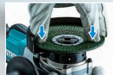
[取付け] 砥石を押し込むだけ
